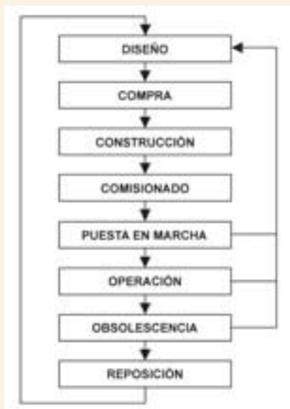
Figura 3. Ciclo de vida de una instalación. Fuente: Instituto de la Energía ISE
