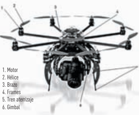
Octocóptero con cámara fotográfica en su parte inferior. Fuente propia
