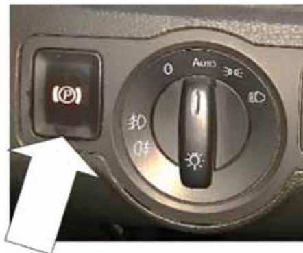
Figura 2: Freno Electrónico de Estacionamiento (EPB).
