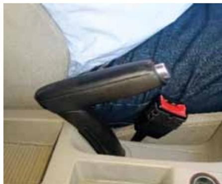
Figura 1: Freno de estacionamiento o "freno de mano".
