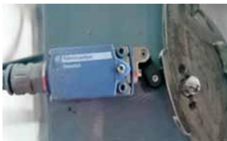
Final de carrera de tipo rodillo de la casa fabricante de sensores Telemecanique
