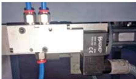
Conexión del solenoide con la electroválvula de la casa fabricante Aignep
