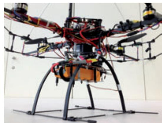
**Actualmente, se está trabajando en la implementación de un control x-y por flujo óptico desde la tarjeta IGEP. La validación del algoritmo de estimación, se realizará a partir de la medida proporcionada por un sensor láser (Hokuyo).**
