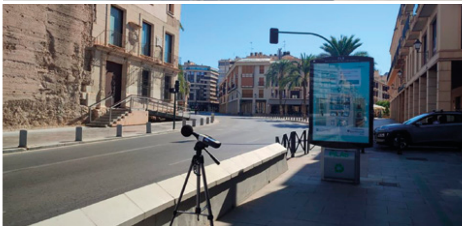
Figura 2: Toma de datos en zona Diagonal del Palau con sonómetro Integrador tipo 1.
