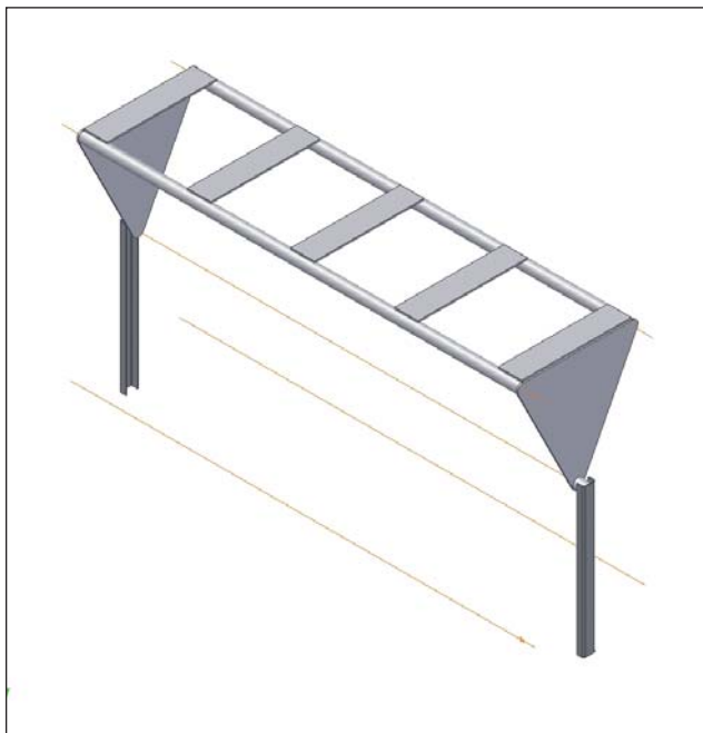
Figura 3. Plataforma en lugar más inestable girando a 180° y centro de gravedad más alto
