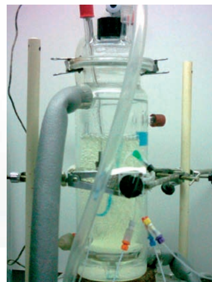
F3. Reactor con una disolución de AIT+Ozono.
