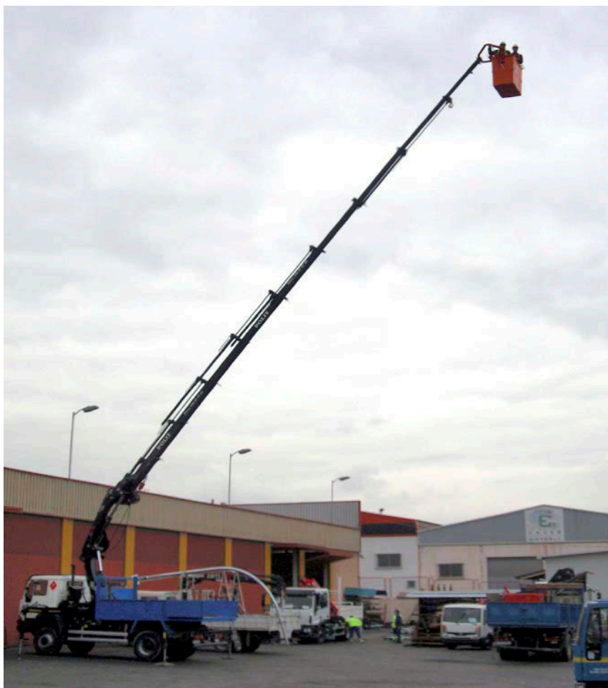
Imagen 2. Vista prueba dinámica con sobrecarga del 10%
