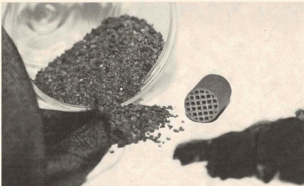
Una muestra del carbón activo empleado en los filtros diseñados por la UA para los equipos de emergencia
