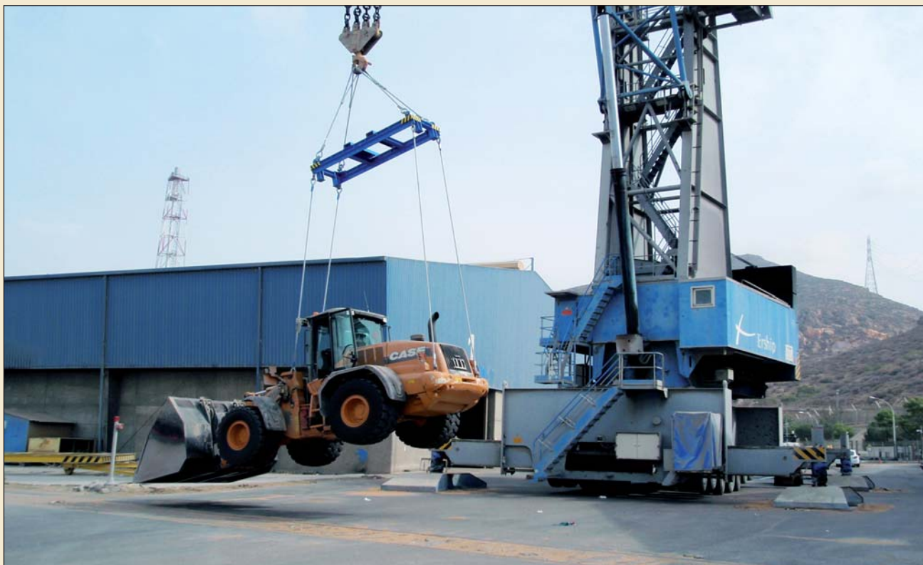
Imagen 2. Vista prueba estática del spreader 10 toneladas, realizada con una carga (pala cargadora de 15000 kg)
