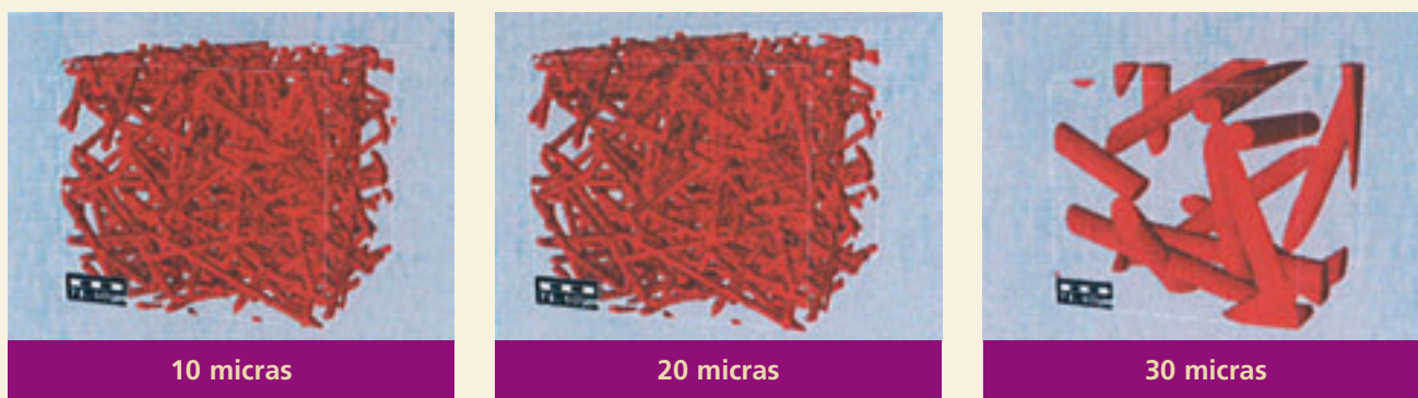
Figura 5. Simulación de Geodict, variación del diámetro de las fibras.
