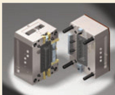
Imagen 19. Vista molde abierto
