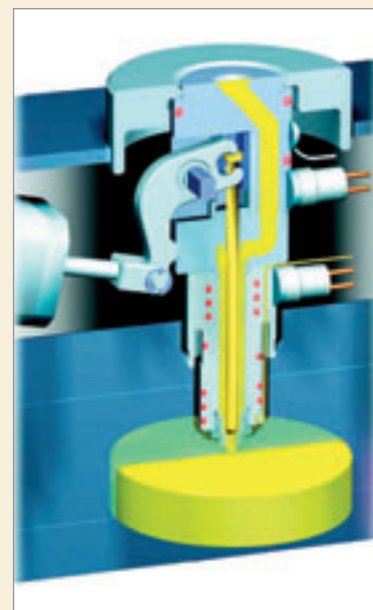
Imagen 9. Vista en sección cámara caliente
