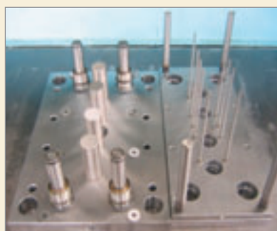
Imagen 21. Sistema de expulsión
