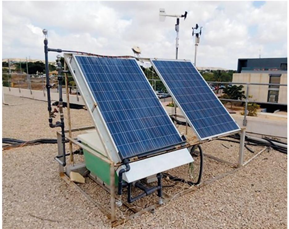
Figura 3. Prototipo de Chimenea fotovoltaica evaporativa. Edificio Torrepinet - Campus UMH (Elche).
