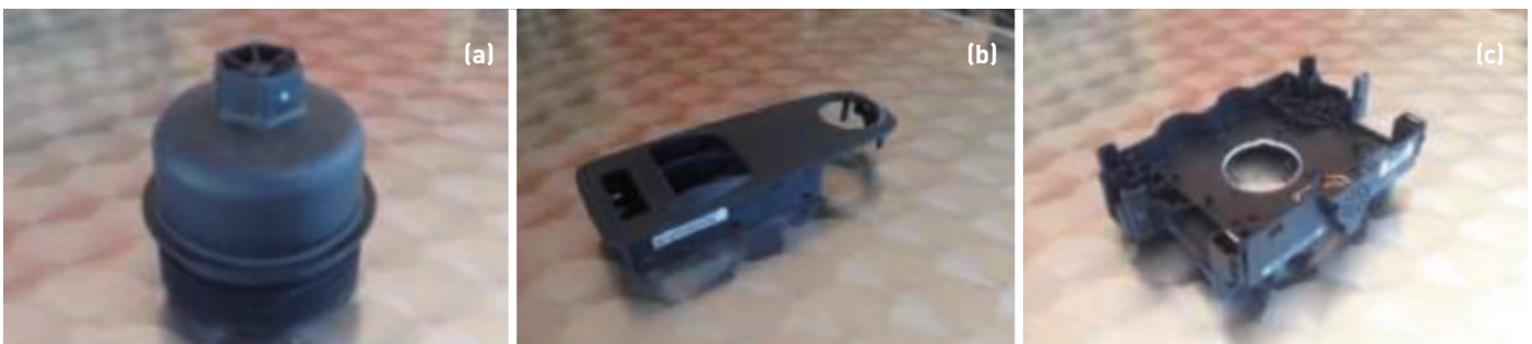
Figura 1.1. a) Imagen de la tapa del filtro de aceite original b) Imagen de la pieza original de la carcasa del mando elevavinas, c) Imagen original de la carcasa del conmutador de luces del Peugeot 207
