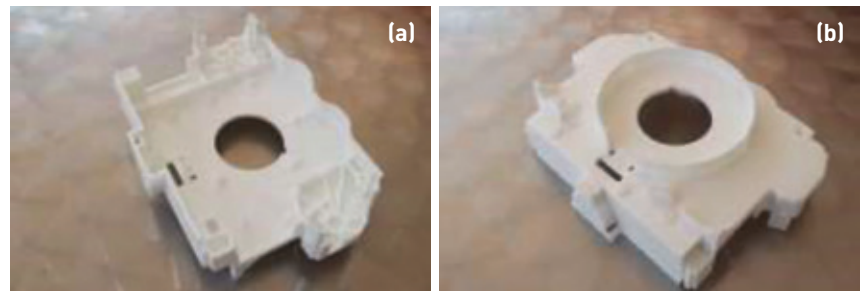
Figura III.2. a) Vista superior de la carcasa de los conmutadores realizada por la impresora Prusa, b) Vista de la parte inferior de la carcasa de los conmutadores realizada por la impresora Prusa
