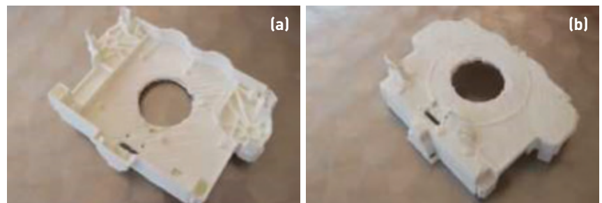
Figura III.3. a) Imagen superior de la carcasa realizada mediante la impresora 3D XYZ DaVinci, b) Imagen de la parte inferior de la carcasa impresa mediante la impresora 3D XYZ DaVinci
