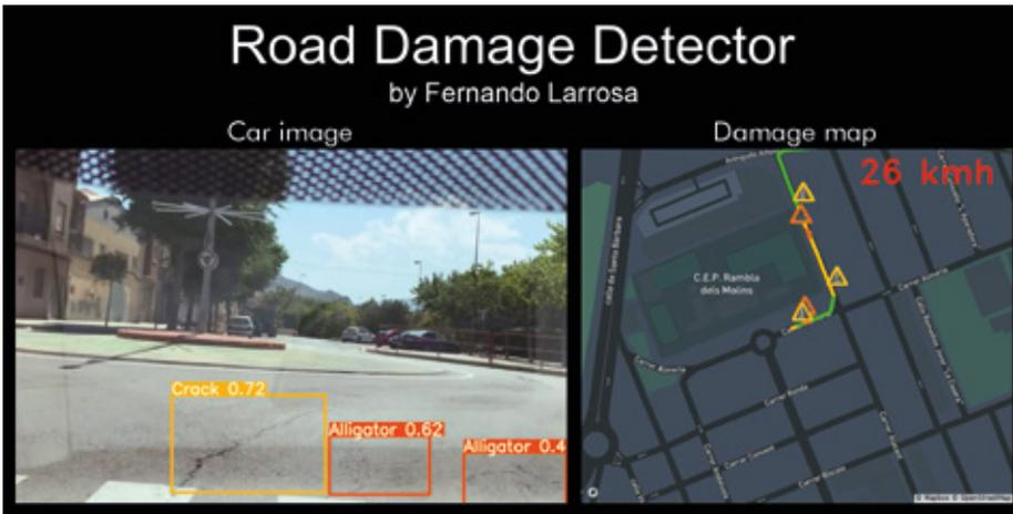
Figura 6.17: Detección de una grieta longitudinal y dos grietas de cocodrilo en la ruta 3.
