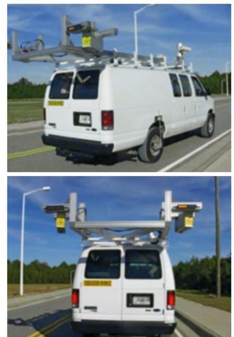
Figura 2.1: Vehículo sensorizado del instituto tecnológico de Georgia para la recolección de datos 3D sobre la superficie del pavimento. Fuente: [2].
