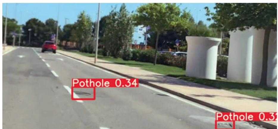
Figura 6.16: FP de una alcantarilla que se confunde con un bache y TP de un bache en la ruta 2.
