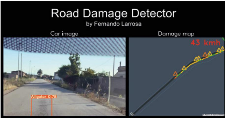
Figura 6.10: Detección de una grieta de cocodrilo con una confianza del 78% en la ruta 1.
